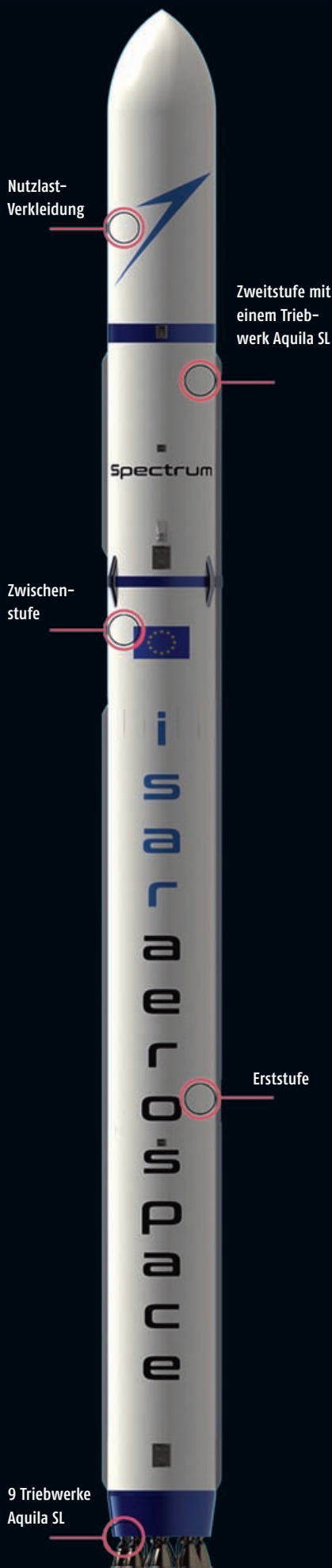
Grundsätzlicher Aufbau der Spectrum-Rakete von Isar Aerospace
