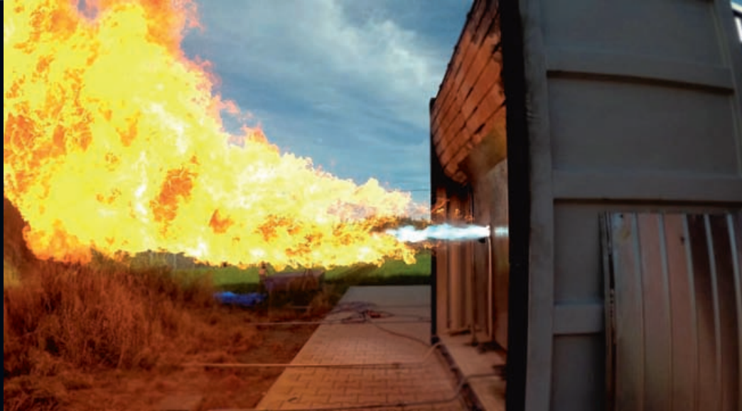
Brenntest eines Triebwerks. Die Treibstoffe sind ein Kohlenwasserstoff und Flüssigsauerstoff.
