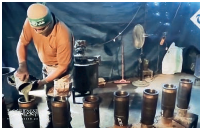
Die Sprengköpfe werden mit erwärmten und daher flüssigem TNT versehen. Eine andere Sektion der Qassam ist mit Sprengstoff und Schrapnellen gefüllt.
