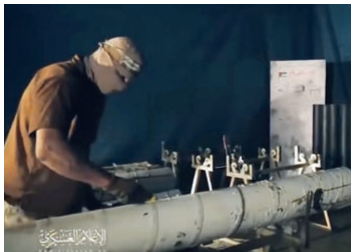
Beim nächsten Schritt werden die Rohre außen glatt geschliffen, oben mit einem Deckel verschlossen und unten wird eine Düse angebracht.
