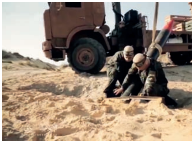
Größere Raketen starten entweder aus eingegrabenen Stellungen oder aus Batterien von einzelnen Startschienen.
