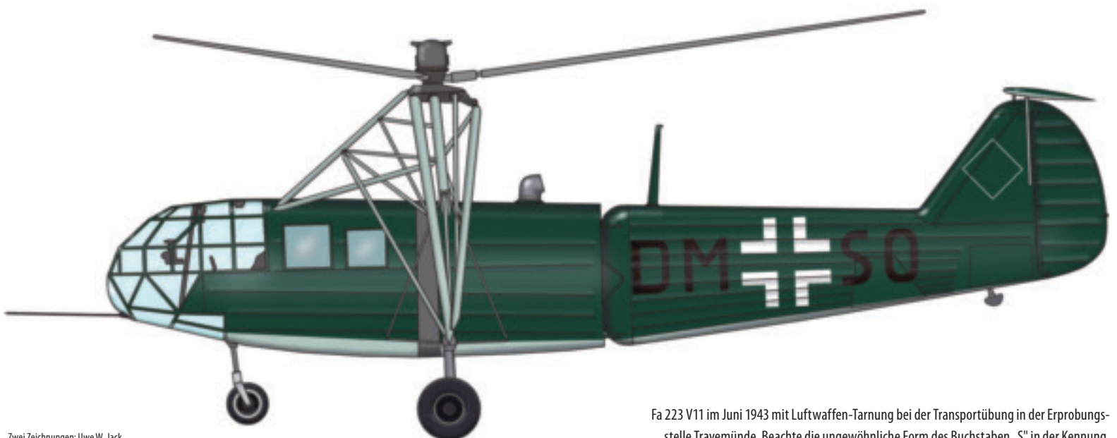
Fa 223 V11 mit Fahrt-Messsonde vor dem Cockpit in der Erprobungsfargebung. Beachtenswert ist das fehlende Hakenkreuz am Leitwerk. So landete die Maschine am 20. März 1943 nach Getriebeschaden nahe Emstal südlich von Berlin.
