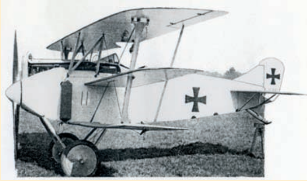
Oben und links: AEG D.I für den Dreidecker-Wettbewerb. Deutlicher Unterschied zum Fokker-Entwurf ist der Reihenmotor mit Seitenkühlern und das Seitenleitwerk mit feststehender Flosse.
