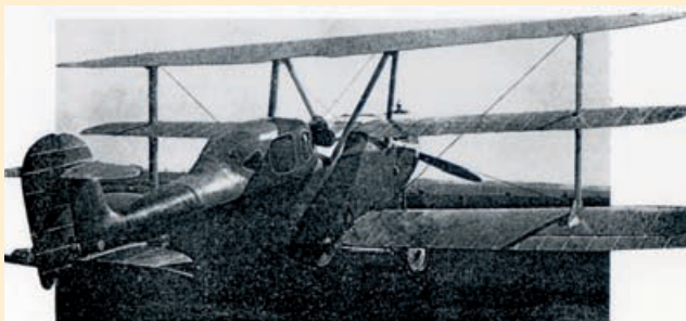
Die Roland D.IV war mit einem Mercedes-Reihenmotor von 160 PS ausgerüstet. Rechts: Auch Seeflugzeuge wurden als Dreidecker ausgelegt.
