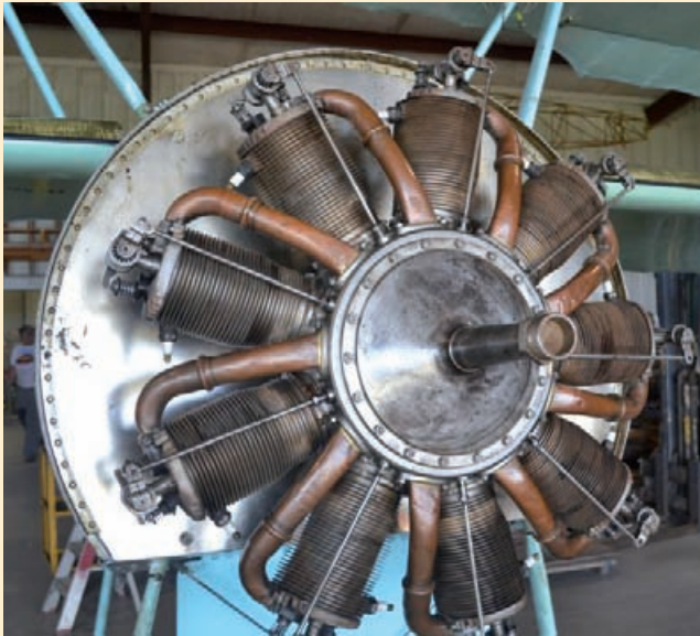
Einbau des Gnome-Rhone-Umlaufmotors im Dr.I-Nachbau des Pioneer of Flight Museum. Rechts ist er unter der Motorverkleidung zu erkennen.
