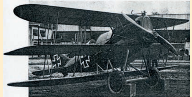
Mit zusätzlicher dritter Tragfläche ging der D.F.W. Kampfeinsitzer in die Konkurrenz.
