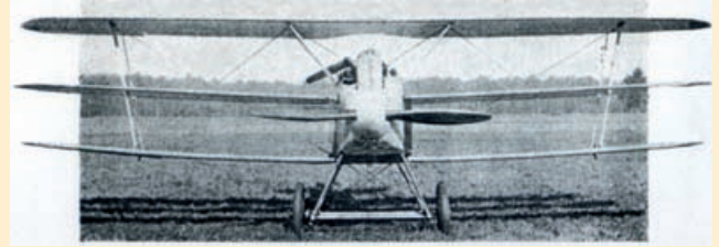
Oben und links: AEG D.I für den Dreidecker-Wettbewerb. Deutlicher Unterschied zum Fokker-Entwurf ist der Reihenmotor mit Seitenkühlern und das Seitenleitwerk mit feststehender Flosse.
