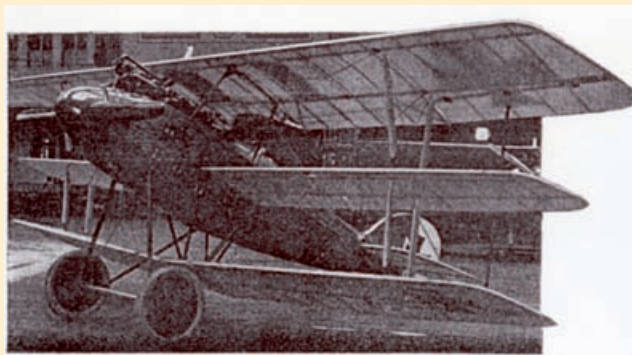
Die Roland D.IV war mit einem Mercedes-Reihenmotor von 160 PS ausgerüstet. Rechts: Auch Seeflugzeuge wurden als Dreidecker ausgelegt.
