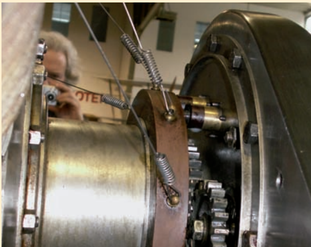
Die Zündsteuerung mit den beiden Kontakten hinter der rotierenden Scheibe.
