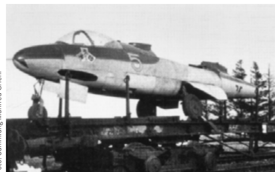
Rumpf und Klappen dieser He 162 sind in Hellblau RLM 76 gehalten. Da von verschiedenen Herstellern fabriziert, sind die Farben unterschiedlich hell.
