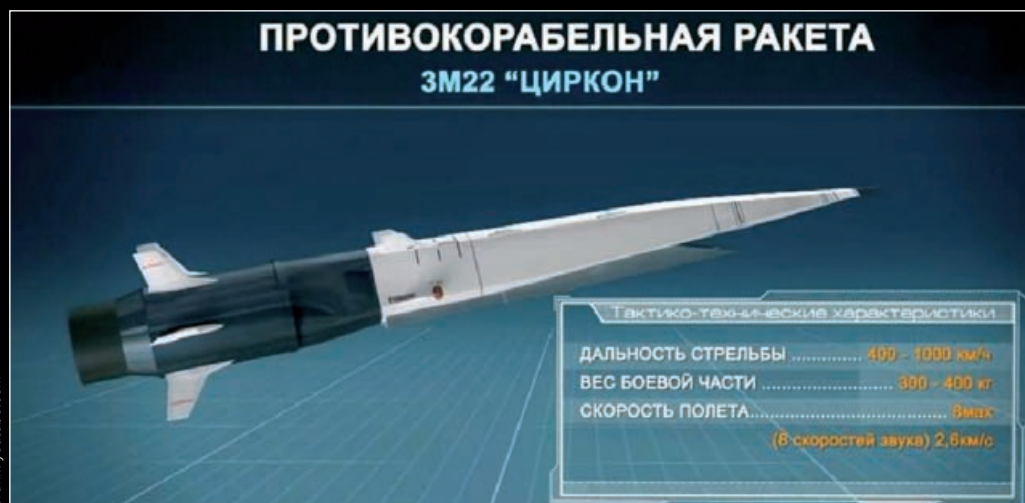
Der russische Lenkflugkörper 3M22 Zirkon wird von U-Booten gegen Schiffe gestartet. Sein Ziel kann er aus 500 km Entfernung mit Mach 8 bis 9 anfliegen.
