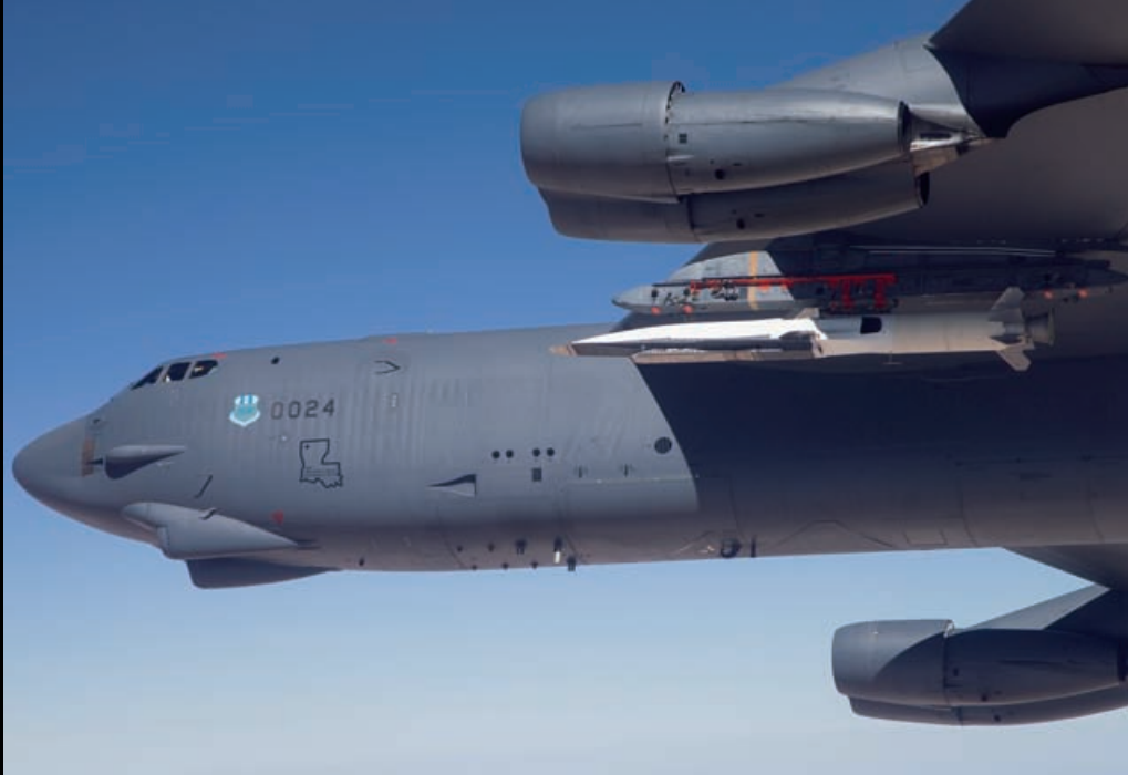
Die Boeing X-51A Waverider unter dem Trägerflugzeug Boeing B-52. Das Feststoffbooster ist deutlich zu sehen. Der Flugkörper erreichte nur knapp Mach 6 statt der erwarteten Mach 7.
