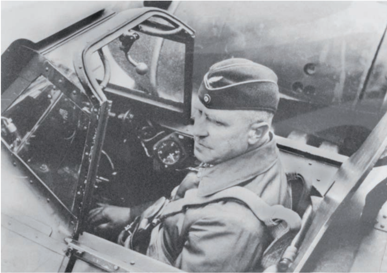
Blick in das Cockpit eines Bf-110-Nachtjägers, beachtenswert ist die Panzerplatte im Rücken des Piloten.
