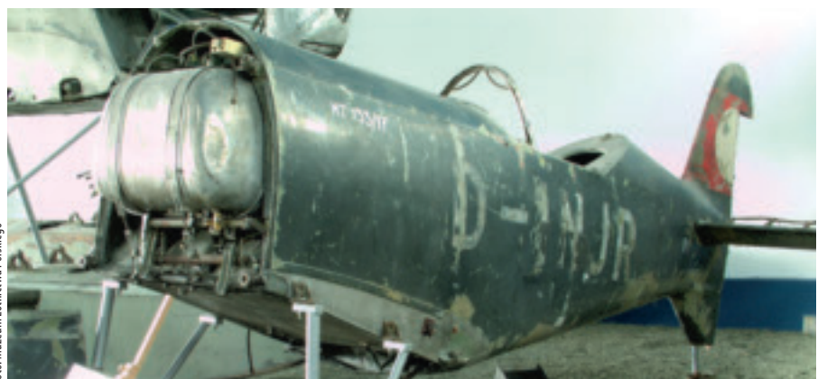
Oben: Die Backbordseite der Me 209 trägt noch die Kennung D-INJR, vorne liegt der Wassertank. Links: Die Spornkufe hatte einen beachtlichen Federweg.
