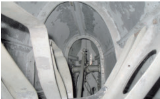
Oben: Blick in den Rumpf der Me 209 nach hinten zur Schubstange für das Höhenruder. Rechts: Im Cockpit fehlen etliche Instrumente, die vermutlich von Andenken-sammlern entwendet wurden.
