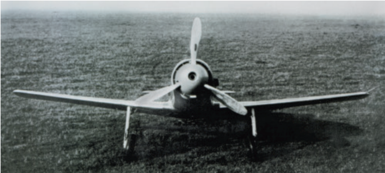
Die Me 209 V1 von vorne gesehen. Der schmale, ringförmige Lufteinlauf für den Ölkühler hinter dem Spinner ist deutlich zu erkennen.
