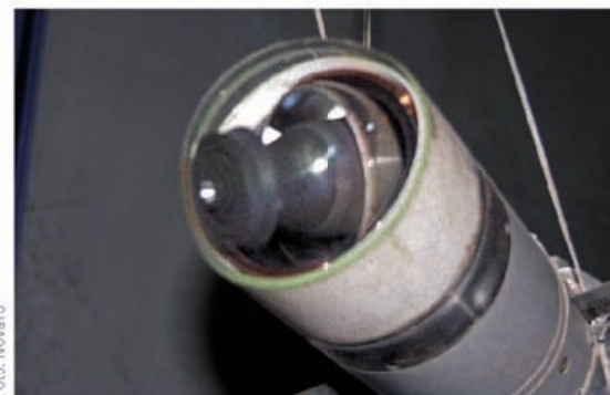
Die Infrarot-Kamera in der Spitze der Stinger ist hier ganz nach unten geschwenkt.
