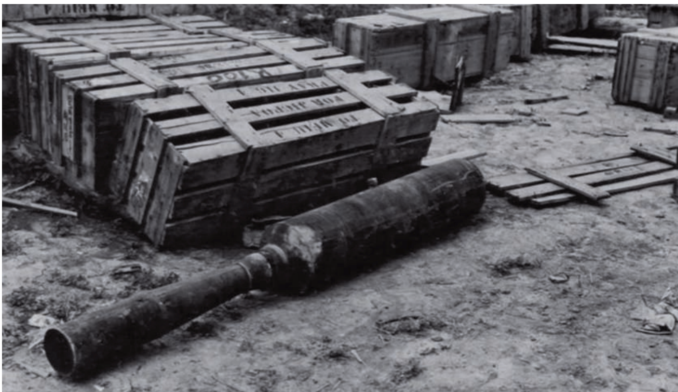
Ein komplettes Triebwerk für eine Ohka Modell 11 bereit zum Einbau.
