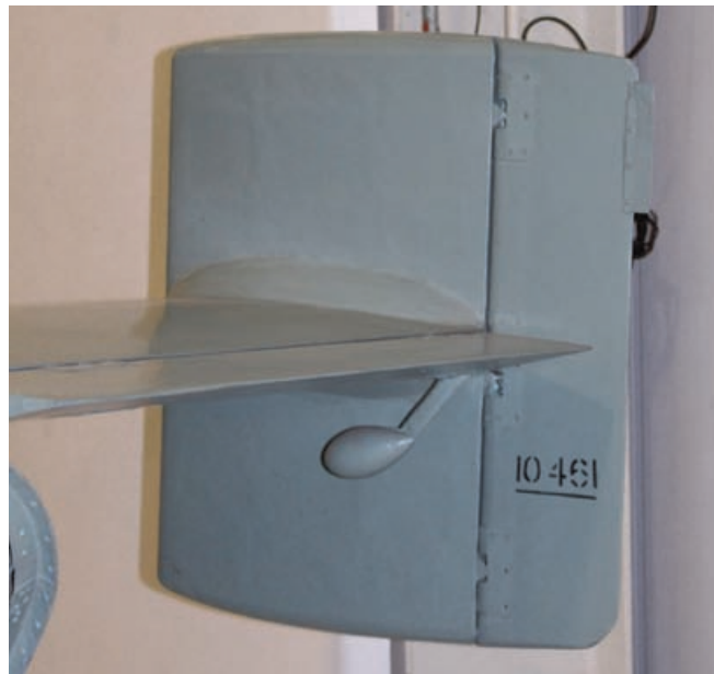
Das Seitenleitwerk der Ohka in Cosford von außen gesehen (links) mit dem Ausgleichsgewicht für das Seitenruder, und von innen gesehen (rechts), mit dem Ausgleichsgewicht des Höhenruders im Vordergrund.
