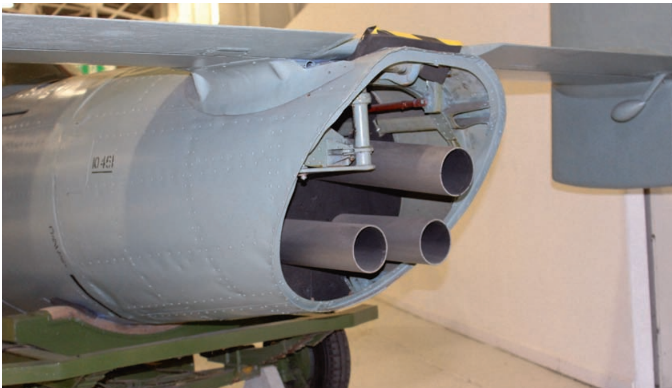
Das Rumpfheck der Ohka Modell 11 in Cosford in der Nahansicht. Oberhalb der hier durch Attrappen ersetzten Raketendüsen sind die Umlenkhebel für die Seitenruder (vorn) und das Höhenruder zu sehen.
